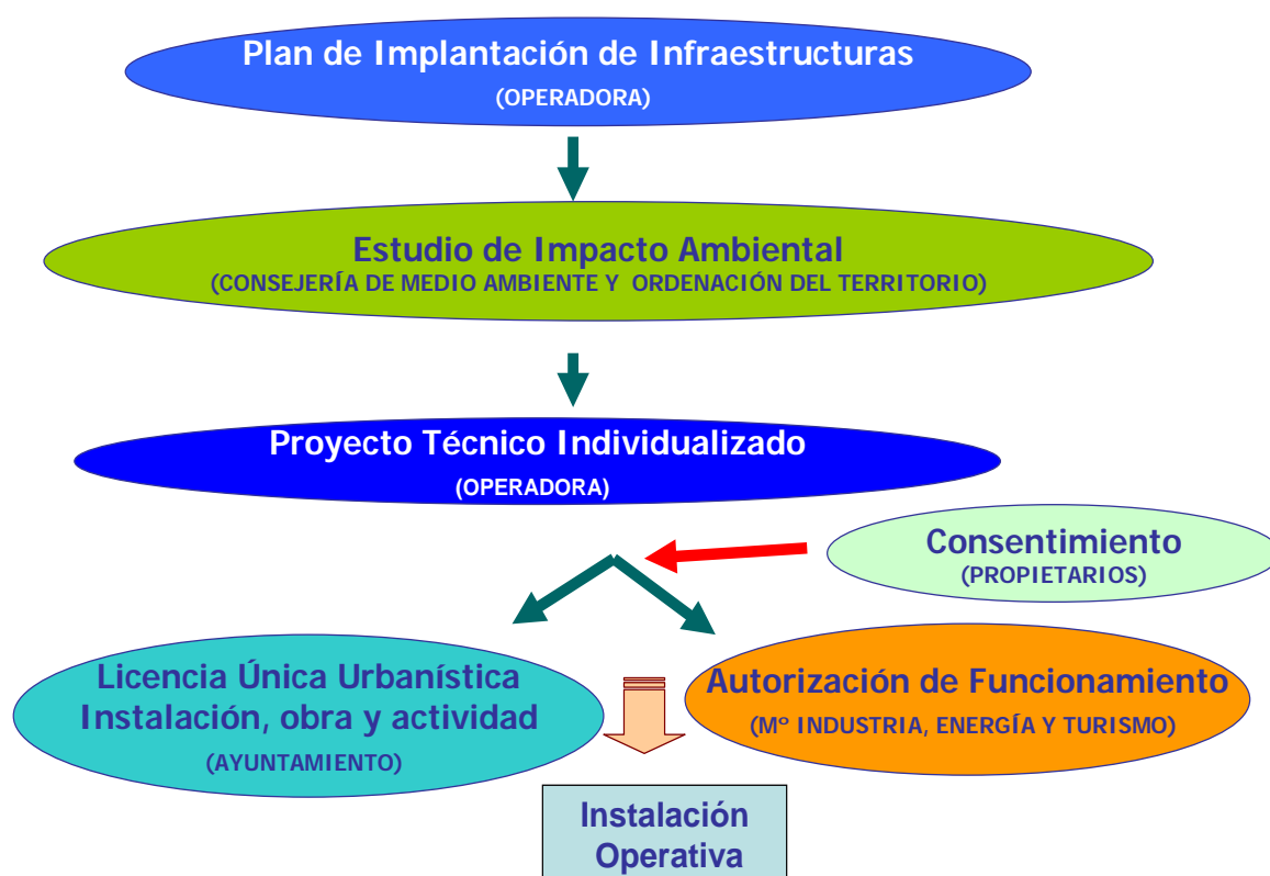
Figura nº 28. Esquema de los pasos a seguir en la instalación de infraestructuras de telefonía móvil.
